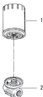
FIGURA 17.6 - TROCA DO ELEMENTO FILTRO DE ÓLEO SRP 4010 À SRP 4040
