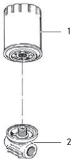
FIGURA 17.6 -CAMBIO DEL ELEMENTO FILTRO DE ACEITE SRP 4010 HASTA SRP 4040
